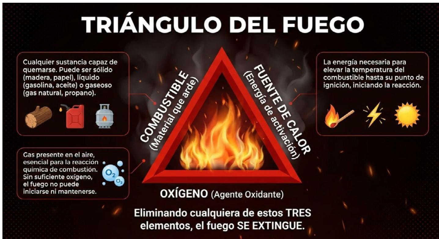
El combustible puede ser cualquier material capaz de arder, como papel, madera, telas, líquidos inflamables o gases. El oxígeno está presente de forma natural en el aire, y la fuente de calor puede provenir de chispas eléctricas, flamas abiertas, superficies calientes o fricción mecánica.
